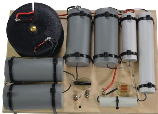
*Die Weiche ist mit ausgesuchten Bauteilen speziell an die Treiber in der Box individuell angepasst*
