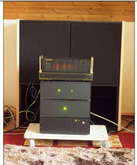
*Das war einmal eine ohnehin schon gute Radford-Endstufe. Für Eder nicht gut genug wird sie mit Megasiebung und externen Netzteilen auferüstet*
