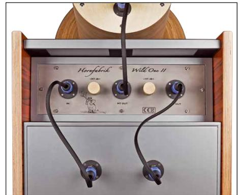
*Die Verkabelung ist so ausgeführt, dass keine Verwechslung passieren kann - der Frequenzgang kann mit den Reglern beeinflusst werden*
